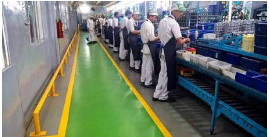
アトラスホンダ社のカラチ工場 エンジン組立エリアに施工したユークリート床材
